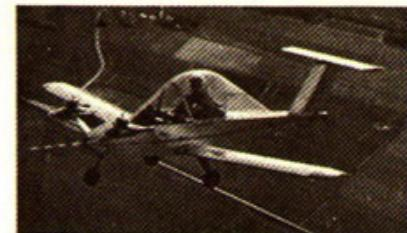
Μῆκος ἀτράκτου 3,60, ἐκπέτασμα πτερύγων 5 μ. Δύο χινητηράκια ἀπὸ ἀλυσιδοπρόνο 8 ἵππων ἔκαστο. Ἀεροτομή στρωτῆς ροῆς, καὶ ίδον πῶς πετά τὸ γαλλικὸν «Cricri». «Ἐνα μεγαλωμένο μοντέλο.
