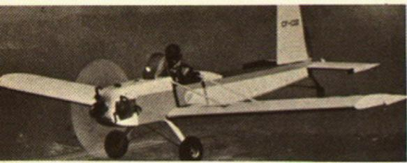
VP—1: Μονοθέσιο ξύλινο έραστεχνης κατασκευής. Άπλο και φθηνό. Κινητήρ VW 1600 κ.έκ.
