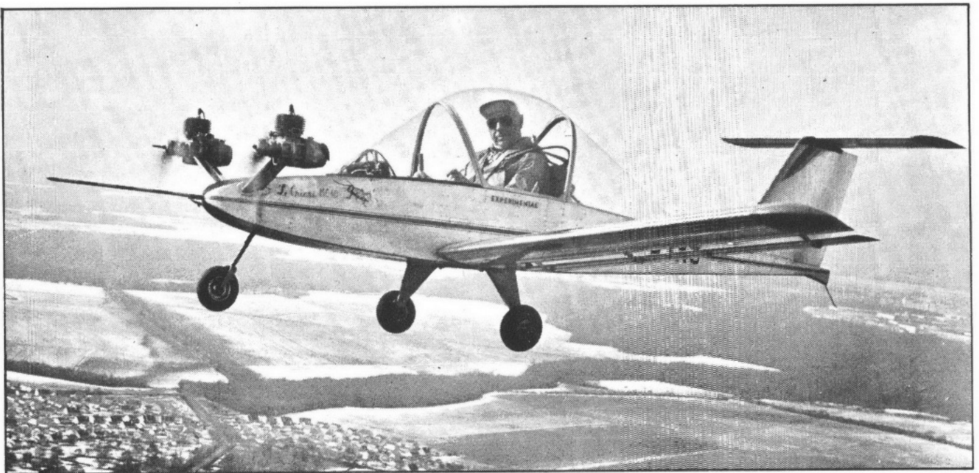
Τό μικρό δικινητήριο αεροπλάνο ἐρασιτεχνικῆς κατασκευῆς Cri - Cri.
